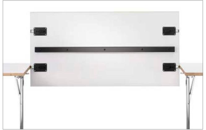
Ici aussi, max fait preuve d'une conception ingénieuse jusque dans le détail. Les crochets des plateaux intermédiaires s'engagent d'abord verticalement dans les anneaux, pour permettre un ajustement précis. Ensuite, ils se rétractent et se verrouillent. Par ailleurs, l'articulation du piétement intègre des butées conçues pour protéger et stabiliser les plateaux empilés en position de rangement.
