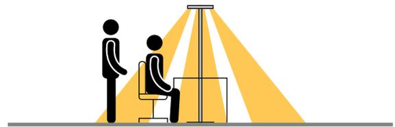
Le fonctionnement des détecteurs de présence et de lumière du jour PULSE PIR dépend de la température. À l'aide de détecteurs de mouvement à infrarouges passifs, le système détecte de façon fiable la présence de personnes au sein d'un champ prédéfini. Les lampes ne sont donc allumées que lorsque les capteurs détectent une présence dans la pièce et que la lumière naturelle ne suffit plus. Grâce à cette technologie, il est possible de réaliser d'importantes économies d'énergie.
